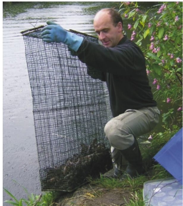
Abb. 2 Michael Höppner mit einem der Hälterungskäfige aus Alurohr und kunststoffkaschiertem Drahtgeflecht
