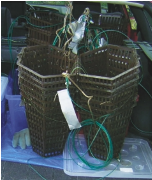
Abb. 1 Die „Pirat“-Reusen, auseinandergeklappt und ineinandergestapelt; an Stahlseil mit PVC-Ummantelung
